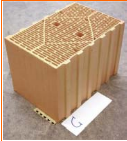
Bild 1: Verwendete Wärmedämmziegel in [6]
